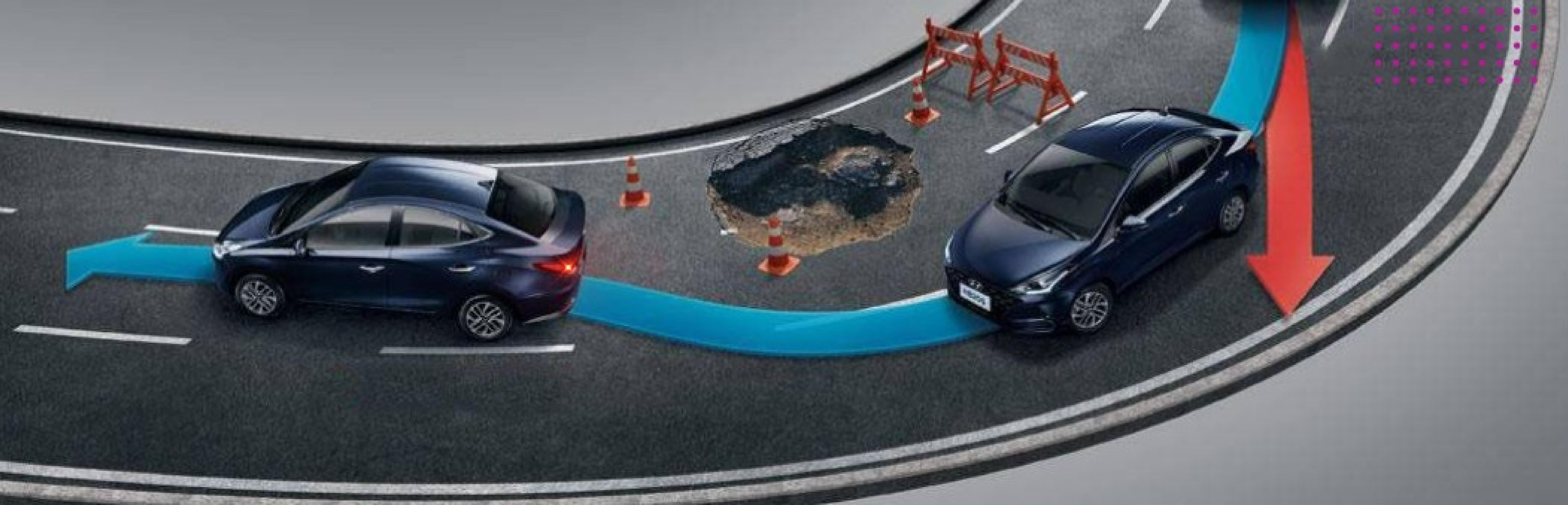
Estos sistemas ayudan a mantener la estabilidad del vehículo en condiciones peligrosas. Actuando sobre la tracción limitando el torque y aplicando los frenos para una seguridad total.
